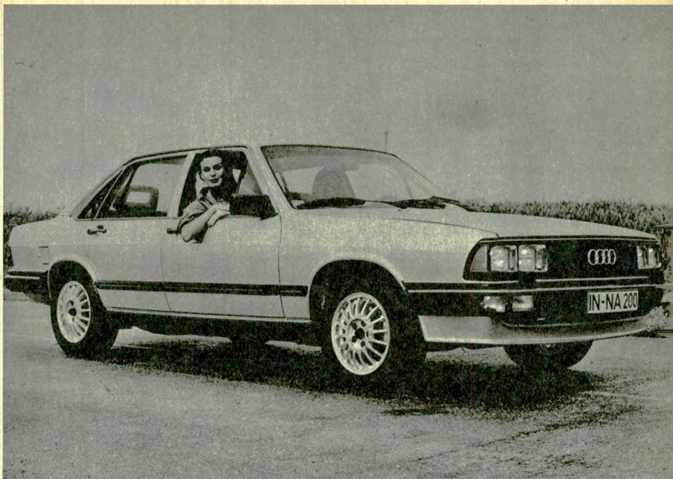
Una imagen del automóvil Audi 200 5T Turbo, que lleva instalado un motor de cinco cilindros y 170 BHP. Es capaz de acelerar de 0 a 100 kilómetros por hora en 8,7 segundos y desarrollar una velocidad máxima de 202 kilómetros por hora.
